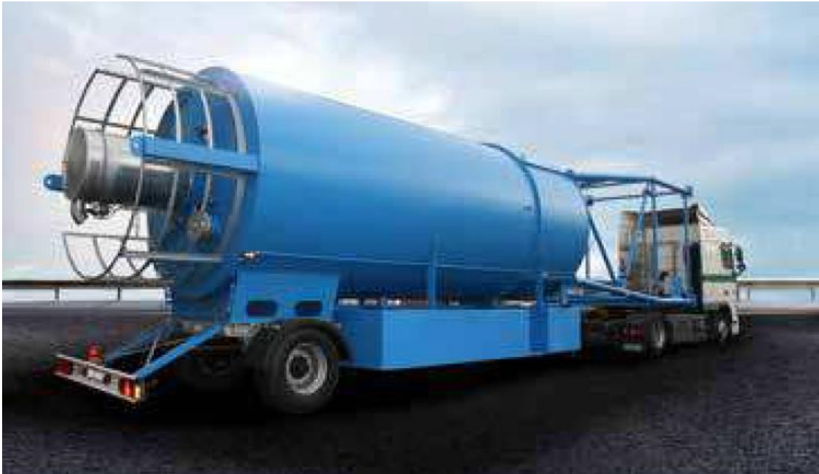
სურათი 9 - შემავსებლის (ფილერის) სილოსი რომელიც მოწყობილია ავტომობილზე
