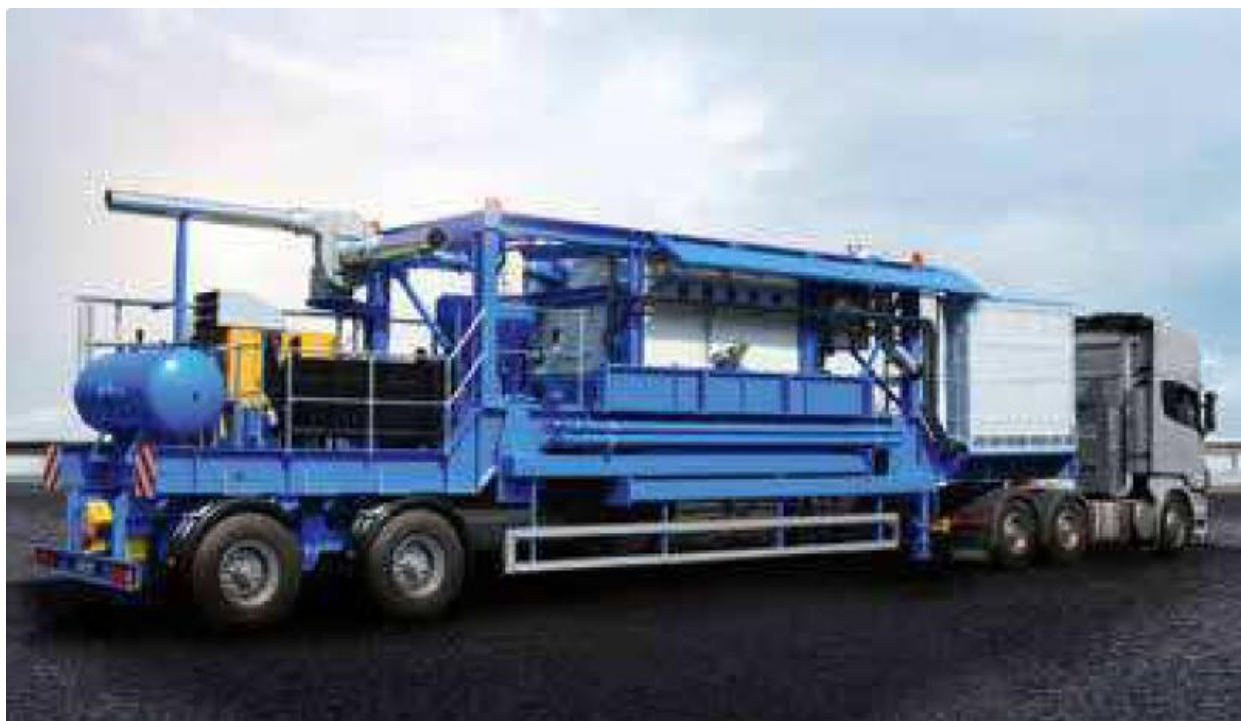
სურათი 8 - ასფალტის შემრევი კომპი, რომელიც განთავსებულია მისაბმელ მოწყობილობაზე
