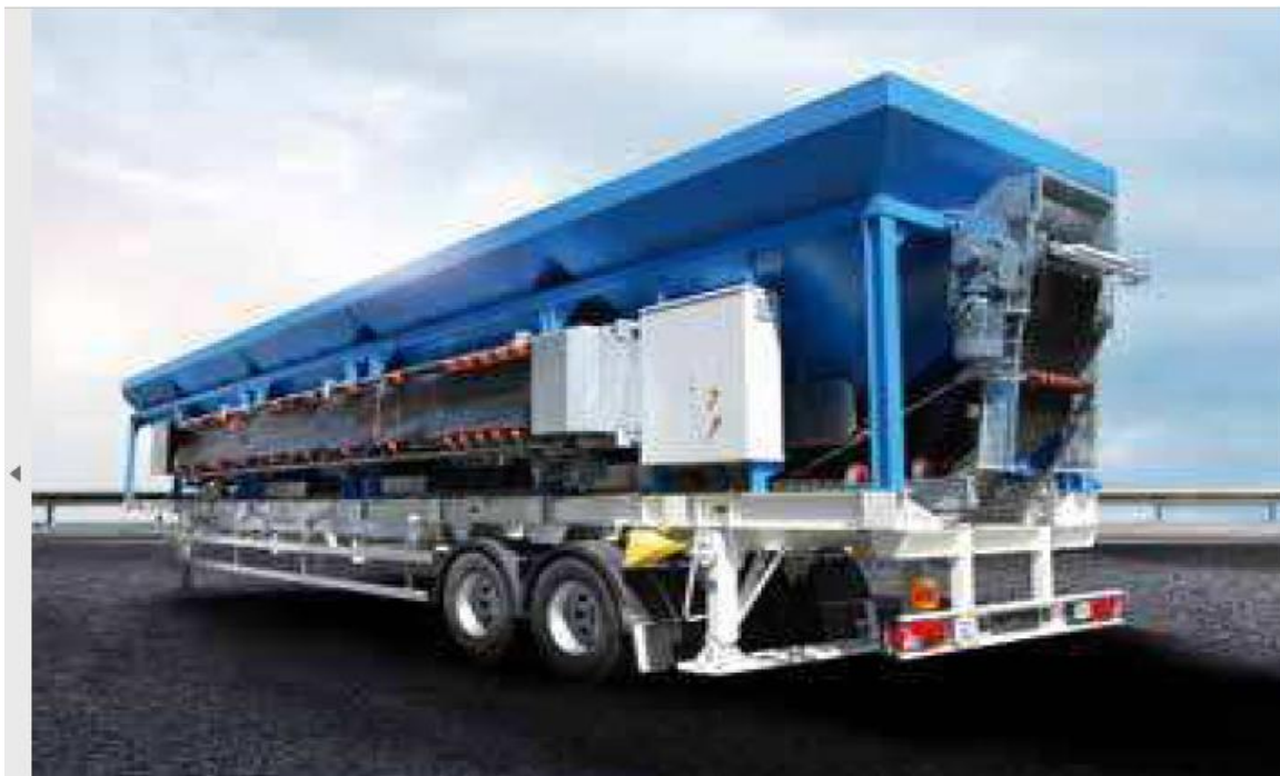
სურათი 7 - სპეციალური ნახევარ მისაბმელი, რომელზეც განთავსებული მკვებავი ბუნკერები
