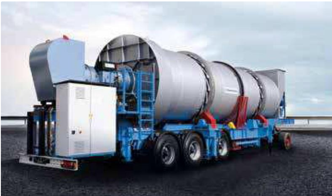
სურათი 10 - საშრობი დოლი რომელიც მოწყობილია სპეციალურ მისაბმელზე
